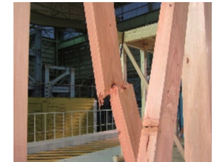
実大木造軸組架構の振動台実験データを用いて妥当性を検証
